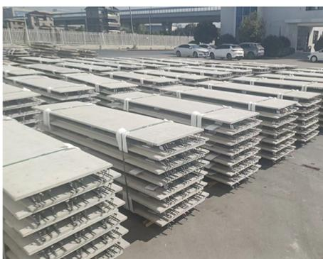
进一步节约材料、提高施工效率而研发的新一代钢筋桁架楼承板产品。该模板系统将钢筋在工厂加工成钢筋桁架，并将钢筋桁架与细石混凝土底模预制为一体，形成底模免拆卸的新型预制装配式钢筋桁架楼承板。楼承板承受混凝土湿料施工期间荷载，楼板成型后混凝土底模板不拆除，作为楼板下保护层并参与结构受力。其广泛适用于各类混凝土及钢结构的住宅、学校、公共建筑等项目中。
